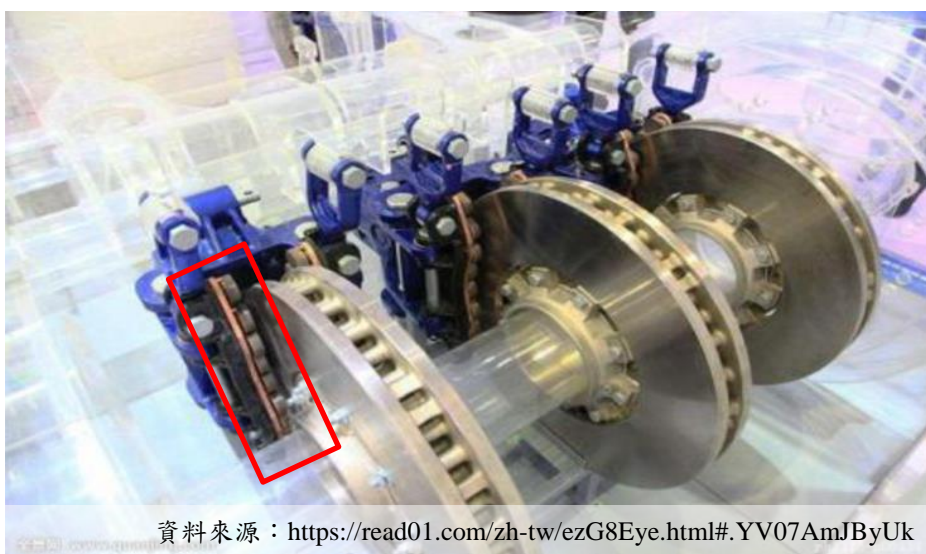
圖 2 碟式制軔之閘瓦位置示意圖
